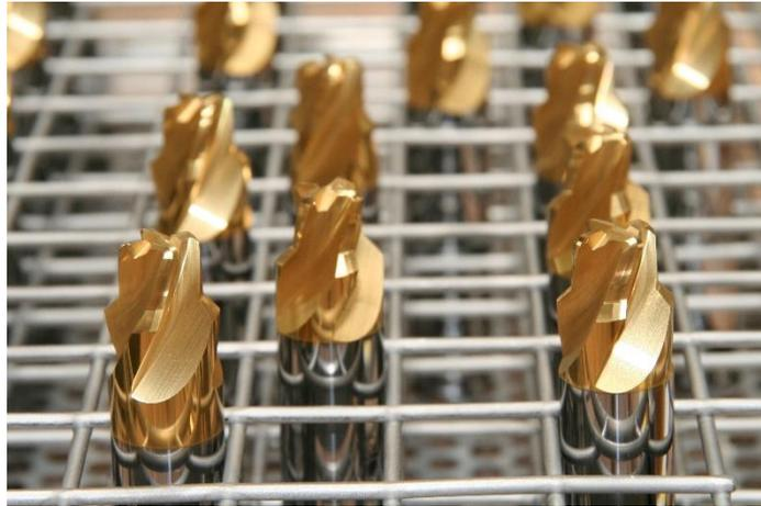
**Figura N°2-** Frese in metallo duro ricoperte con TiN (cortesia miniToolsCoating)
